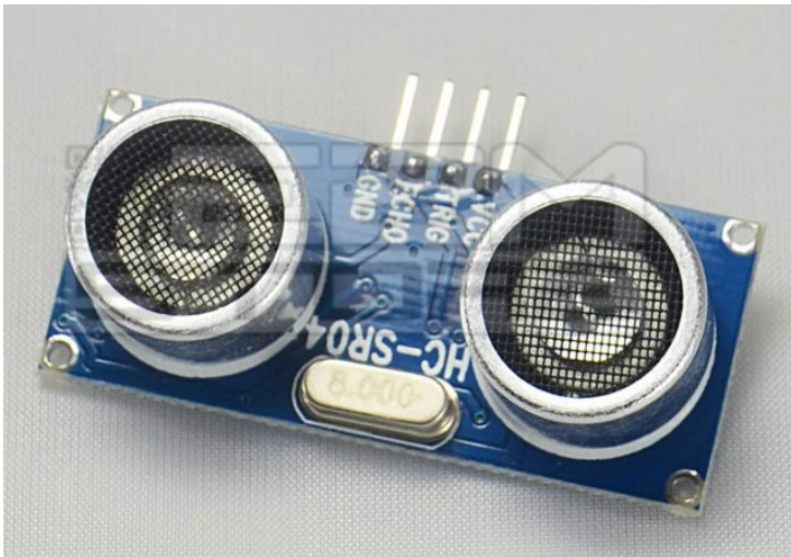
Metro ad ultrasuoni con sensore HC-SR04
